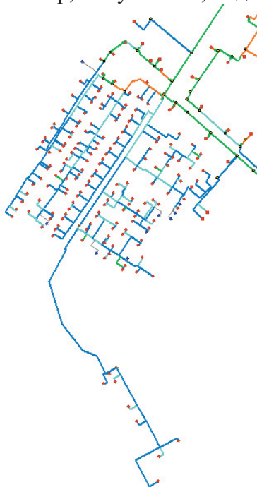
Рис. 10 Схема распределения скоростей теплоносителя района Заречный.
