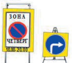
Размещение временных дорожных знаков на передвижных опорах
