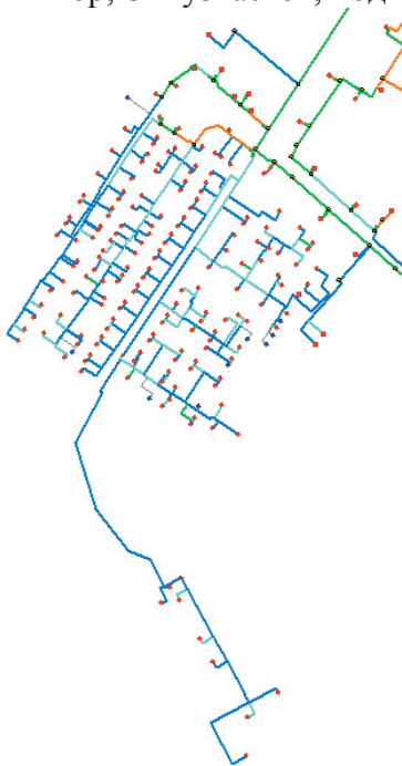
Рис. 10 Схема распределения скоростей теплоносителя района Заречный.
