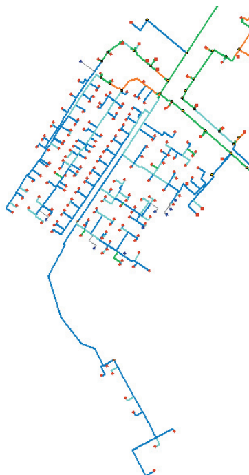
Рис. 10 Схема распределения скоростей теплоносителя района Заречный.
