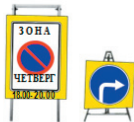
Размещение временных дорожных знаков на передвижных опорах
