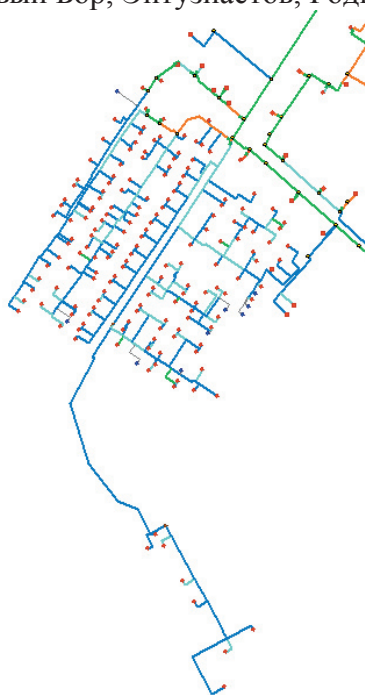
Рис. 10 Схема распределения скоростей теплоносителя района Заречный.
