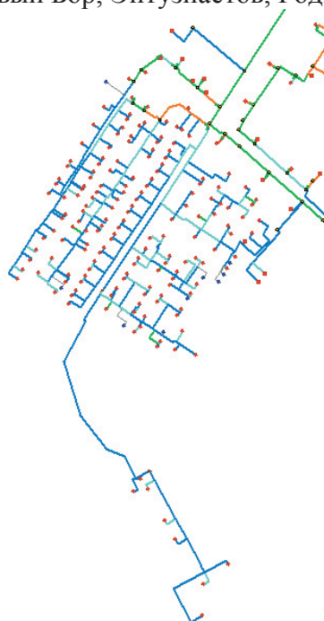
Рис. 10 Схема распределения скоростей теплоносителя района Заречный.
